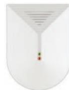
Rivelatore acustico di rottura vetri, con sensibilità regolabile: copertura fino a m 9 con sensibilità alta, e fino a m 4.5 con sensibilità bassa. Analisi completa dello spettro acustico ad infrasuono, filtri digitali su 7 frequenze, amplificatore digitale di guadagno e valutazione della variazione di frequenza, alta immunità alle interferenze EMI e RFI con filtro digitale.
