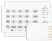
Tastiera con indicatori LED 10 zone e sportello orizzontale di protezione dei tasti, indicatori LED separati per la visualizzazione dello stato d'inserimento Totale, Notturmo, Perimetrale e Disinserito di ciascuna delle 2 aree. Possibilità di regolazione della luminosità. Collegamento su BUS (max. 15 tastiere). 1 ingresso di zona.
