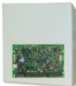
Modulo controllo accessi per 1 lettore con collegamento su BUS. Consente l'accesso e/o l'inserimento e disinserimento del sistema con sola scheda, con solo codice, oppure con scheda e codice. Comando automatico sblocco porta, opzioni per porta aperta e per porta forzata, temporizzazioni per sblocco porta e per ritardo esteso, sblocco porta manuale con pulsante o uscita programmabile, opzione sblocco porta su allarme incendio. Fornito in armadio metallico mm 200x255x76. Richiede trasformatore.
