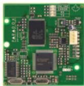
Modulo combinatore vocale. Chiama fino a 5 numeri telefonici (8 con le centrali DIGIPLEX EVO) per riportare un allarme intrusione, aggressione, incendio, mancanza e ripristino rete e batteria bassa centrale utilizzando messaggi vocali. Personalizzazione di un messaggio vocale di 15 secondi. Permette l'inserimento/disinserimento del sistema e l'attivazione delle uscite programmabili a distanza tramite qualsiasi telefono. Inserimento ad innesto sulla scheda della centrale.
