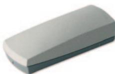
**Modulo uscita PGM senza fili**, bidirezionale. Dispone di 1 uscita relè 5A programmabile per inserimento/disinserimento, allarme, attivazione da telecomando, o altri eventi. 1 ingresso zona. Colore bianco. Dimensioni mm 124x45x33. Non compatibile con centrale SPECTRA SP4000. Versione a 433MHz.
